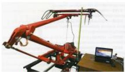
Стенд для определения статической характеристики токоприемника
